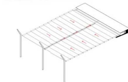
3A montaggio a secco delle canaline per la raccolta delle acque meteorologiche
