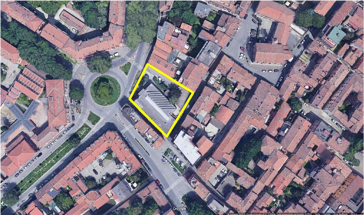
Oggi l'edificio si presenta come un volume di due piani fuori terra a pianta pressoché rettangolare. Poggiato su un basamento direttamente sul terreno il fabbricato ha una copertura piana, accessibile solo per manutenzione, che ospita un impianto fotovoltaico di non recente installazione.
